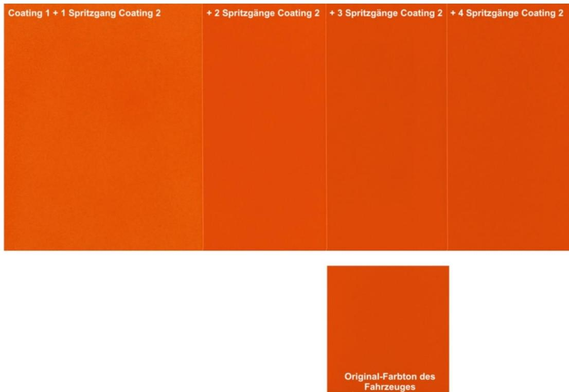
Le peintre peut maintenant déterminer visuellement la teinte dégradée qui correspond au mieux à la peinture d'origine. Dans notre exemple, c'est la plaquette recouverte de « Coating 1 » + 3 passes de « Coating 2 ».
